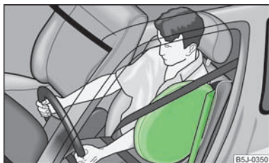
Fig. 103 Airbag latéral gonflé par gaz
