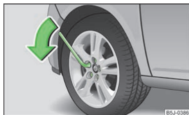
Fig. 133 Changement de roue : Desserrer les boulons de roue
