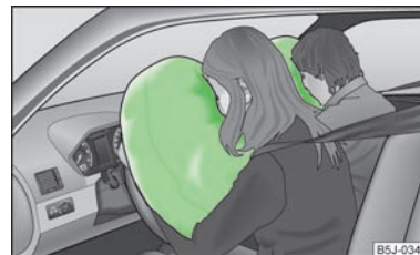
Fig. 101 Sacs remplis de gaz
