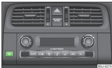
Fig. 28 Contacteur du chauffage de lunette arrière
