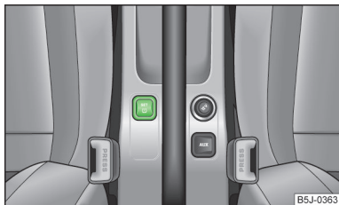
Fig. 134 Touche de réglage de la valeur de contrôle pour la pression des pneus
