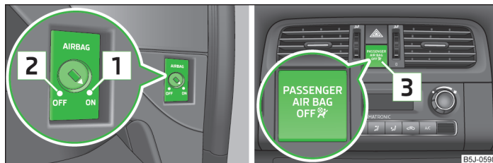
Fig. 116 Commutateur à clé pour l'airbag frontal du passager avant / témoin d'activation/désactivation de l'airbag frontal du passager avant
