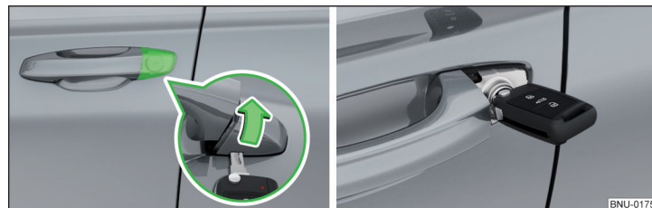
Fig. 324 Poignée dans la portière conducteur : Relever le cache de la serrure / Cylindre de serrure avec clé
