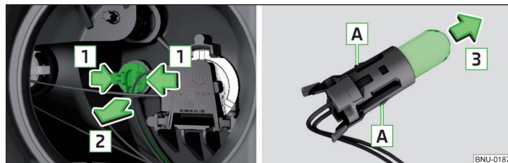
Fig. 339 Remplacement de l'ampoule du feu de position
