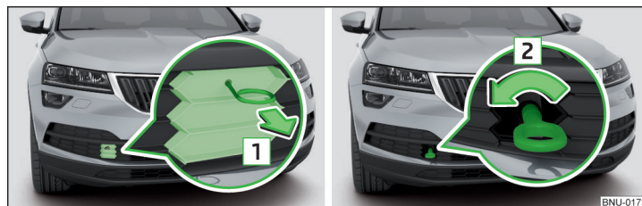
Fig. 319 Retirer la grille / monter l'oeillet de remorquage
