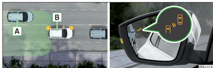
Fig. 259 La situation de conduite / le voyant dans le rétroviseur extérieur de gauche indique la situation de conduite
