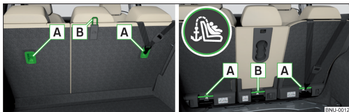
Fig. 28 Œillets pour le système TOP TETHER : version 1 / version 2
