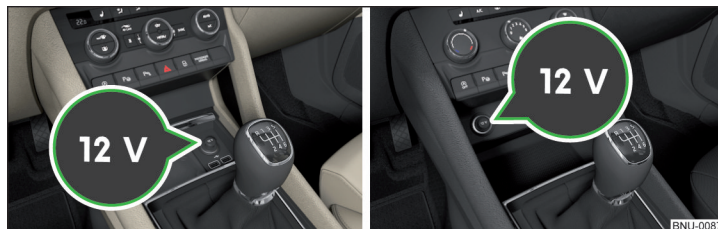
Fig. 117 Couverture de la prise 12 volts
