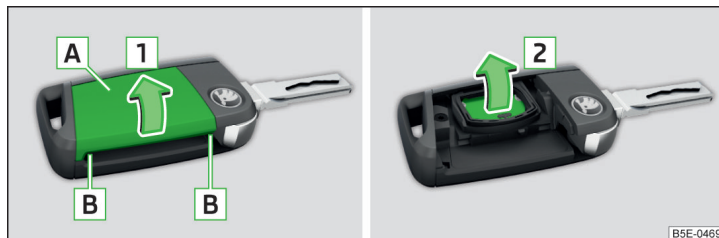
Fig. 321 Démontez le cache / retirez la pile
