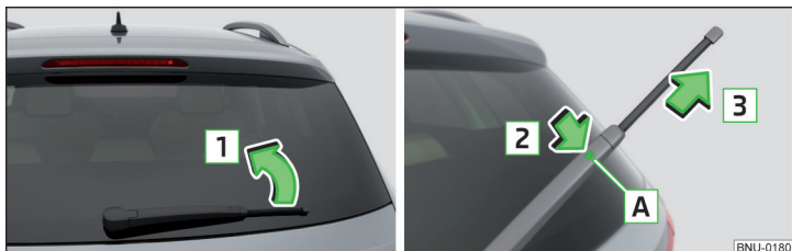
Fig. 330 Changer le balai d'essuie-glace de la lunette arrière
