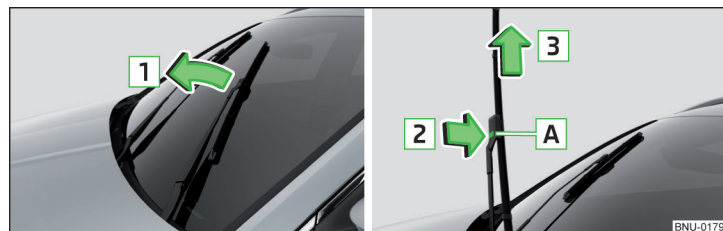
Fig. 329 Changer le balai d'essuie-glace du pare-brise avant
