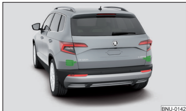
Fig. 257 Emplacement des capteurs de radar
