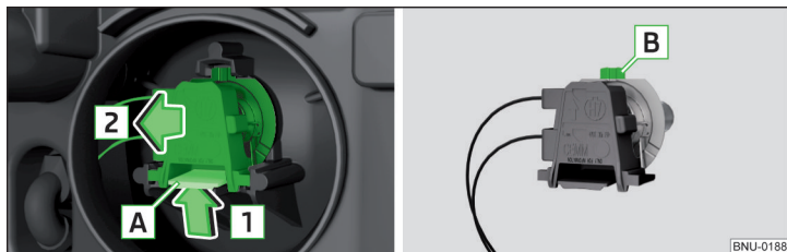
Fig. 338 Remplacement de l'ampoule du feu de croisement et de route
