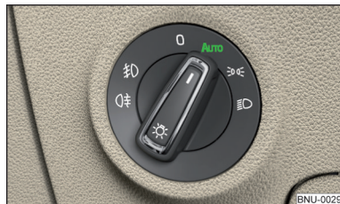
Fig. 59 Commutateur des feux : Position AUTO
