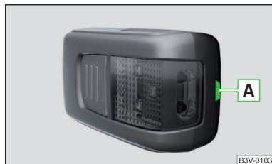
Fig. 323 Clip d'arrêt sur le cache des piles
