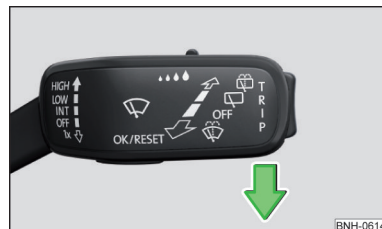
Fig. 328 Régler la position d'entretien des balais d'essuie-glace
