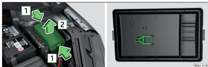
Fig. 335 Cache de la boîte à fusibles : retirer le cache / agrafe en plastique pour les fusibles
