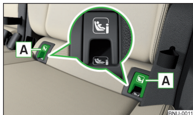
Fig. 27 L'étiquette du système ISOFIX
