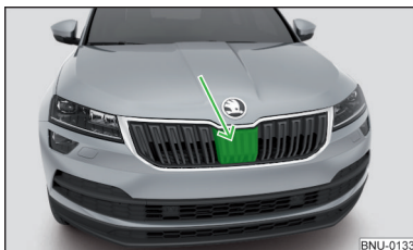
Fig. 248 Emplacement du capteur radar
