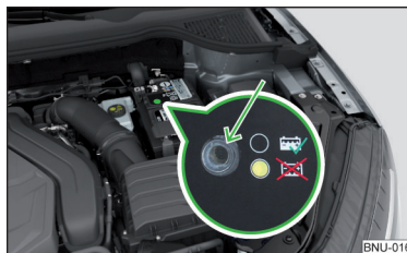
Fig. 302 Batterie du véhicule : Indicateur de niveau de l'électrolyte
