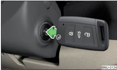
Fig. 236 Démarrer le moteur - maintenir la clé sur le bouton
