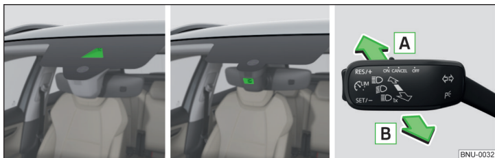
Fig. 60 Variantes de l'emplacement de montage du capteur / Activer/désactiver le système
