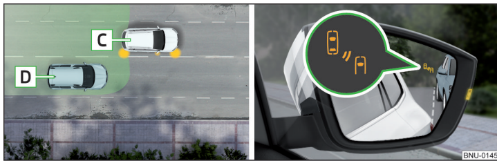
Fig. 260 La situation de conduite / le voyant dans le rétroviseur extérieur de droite indique la situation de conduite
