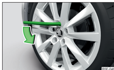
Fig. 313 Desserrer les boulons de roue
