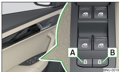
Fig. 48 Sécurité enfant avec commande électrique
