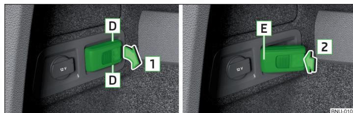
Fig. 154 Enlever la lampe / remettre la lampe
