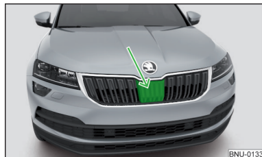
Fig. 257 Emplacement du capteur radar
