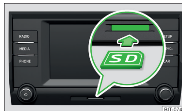
Fig. 190 Swing : Insérer une carte SD
