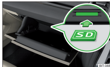
Fig. 189 Columbus, Amundsen, Bolero : Insérer une carte SD
