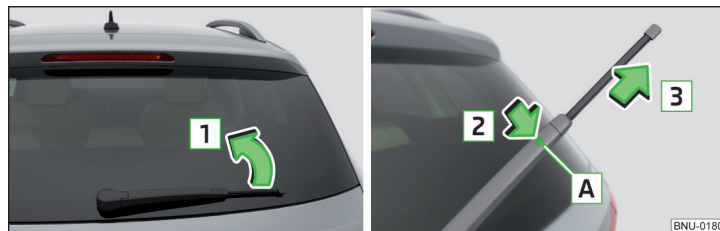
Fig. 339 Changer le balai d'essuie-glace de la lunette arrière
