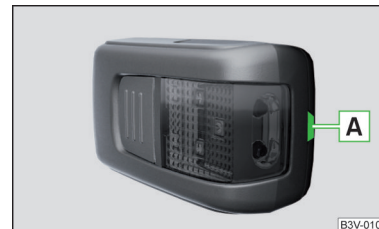
Fig. 358 Clip d'arrêt sur le cache des piles
