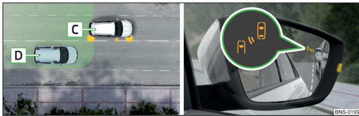
Fig. 276 La situation de conduite / le voyant dans le rétroviseur extérieur de droite indique la situation de conduite
