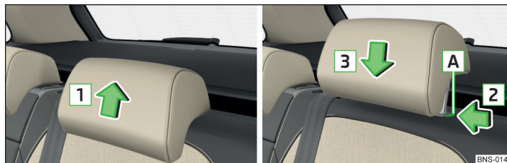
Fig. 83 Régler la hauteur des appuie-têtes de la deuxième rangée de sièges
