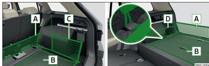
Fig. 127 Exemples de fixation pour les filets : version cinq places / version cinq places avec un sol de chargement variable
