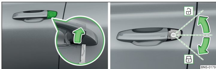
Fig. 359 Poignée dans la portière conducteur : Rabattre le cache de la serrure / déverrouiller et verrouiller
