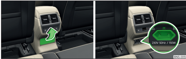
Fig. 118 Rabattre le couvercle de la prise 230 Volts / prise 230 Volts
