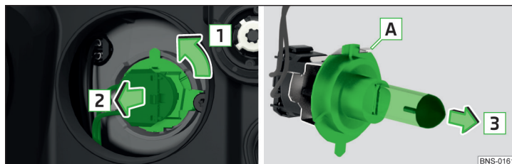
Fig. 376 Remplacement de l'ampoule des feux de route
