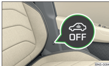
Fig. 43 Touche pour la surveillance de l'habitacle et la protection anti-soulèvement
