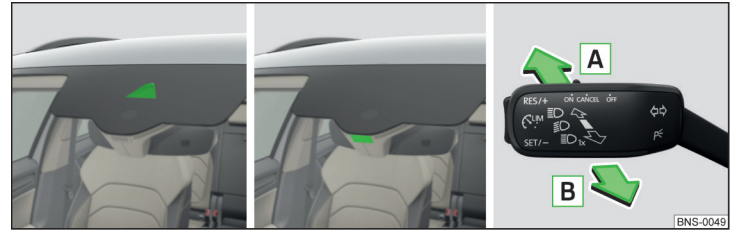
Fig. 55 Variantes de l'emplacement de montage du capteur / Activer/désactiver le système
