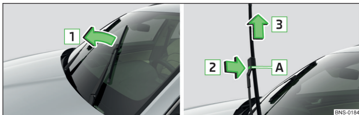
Fig. 365 Changer le balai d'essuie-glace du pare-brise avant
