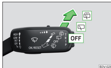
Fig. 66 Commande du système d'essuie-glace et de lavage de la lunette arrière
