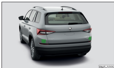
Fig. 273 Emplacement des capteurs de radar
