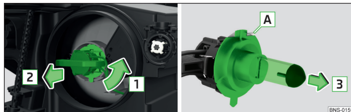
Fig. 374 Remplacement de l'ampoule du feu de croisement
