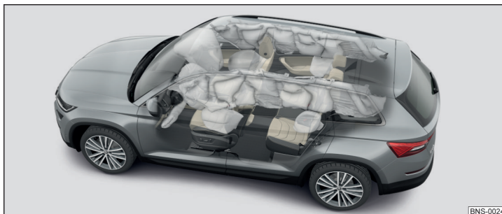
Fig. 10 Airbags remplis de gaz
