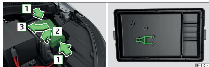
Fig. 371 Cache de la boîte à fusibles : retirer le cache / agrafe en plastique pour les fusibles
