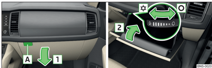
Fig. 106 Ouvrir le vide-poches en bas / fermer le vide-poches en bas et actionner l'arrivée d'air
