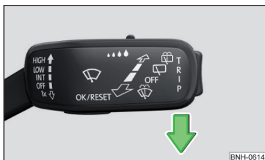
Fig. 364 Régler la position d'entretien des balais d'essuie-glace
