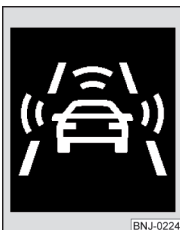
Fig. 310 Écran du combiné d'instruments : Pré-avertissement ou freinage d'urgence à faible vitesse
