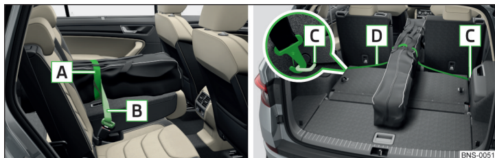
Fig. 114 Fixer le sac de chargement à l'avant/à l'arrière
