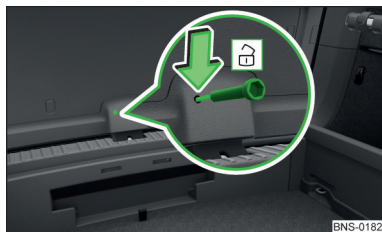
Fig. 362 Déverrouiller le capot
