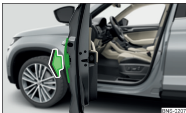
Fig. 39 Retirer la bordure de protection
