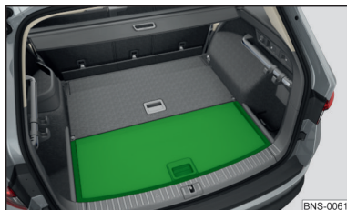
Fig. 158 Sol de chargement variable re- tourné
