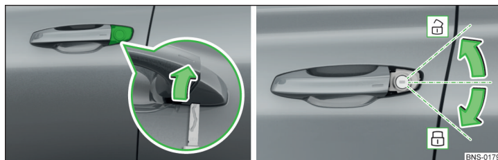
Fig. 353 Poignée dans la portière conducteur : Rabattre le cache de la serrure / déverrouiller et verrouiller
