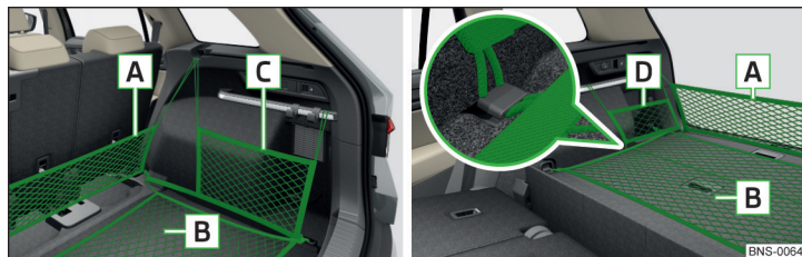
Fig. 142 Exemples de fixation pour les filets : version cinq places / version cinq places avec un sol de chargement variable
