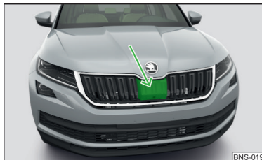
Fig. 262 Emplacement du capteur radar
