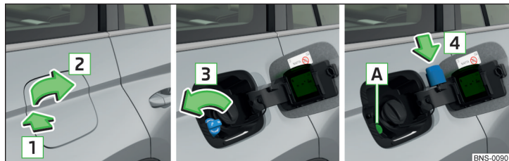
Fig. 322 Ouvrir la trappe du réservoir / Dévisser le bouchon du réservoir / Placer le bouchon du réservoir sur la trappe du réservoir
