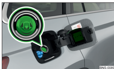
Fig. 321 Tubulure de remplissage de carburant sur les véhicules équipés d'un moteur diesel
