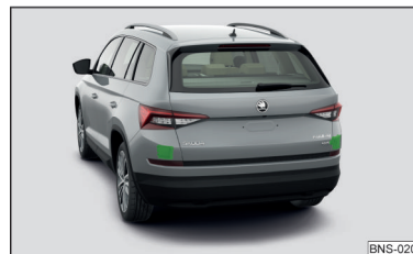
Fig. 271 Emplacement des capteurs de radar
