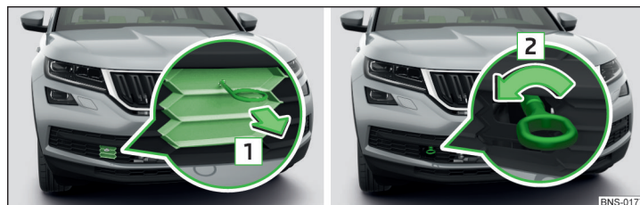
Fig. 349 Retirer la grille / monter l'oeillet de remorquage
