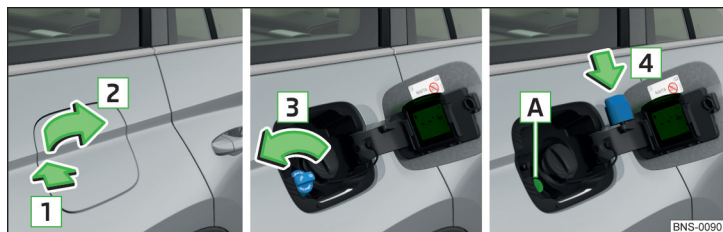
Fig. 323 Ouvrir la trappe du réservoir / Dévisser le bouchon du réservoir / Placer le bouchon du réservoir sur la trappe du réservoir
