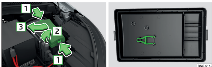
Fig. 368 Cache de la boîte à fusibles : retirer le cache / agrafe en plastique pour les fusibles
