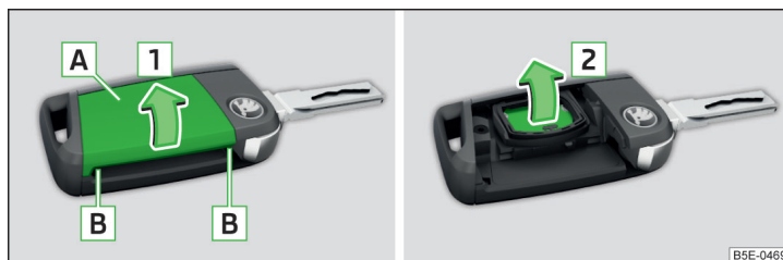
Fig. 351 Démontez le cache / retirez la pile
