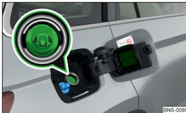
Fig. 322 Tubulure de remplissage de carburant sur les véhicules équipés d'un moteur diesel
