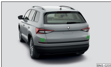
Fig. 272 Emplacement des capteurs de radar
