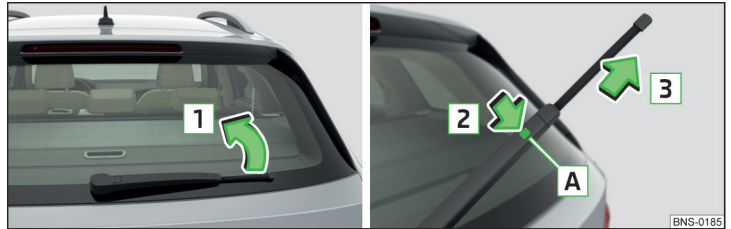
Fig. 363 Changer le balai d'essuie-glace de la lunette arrière
