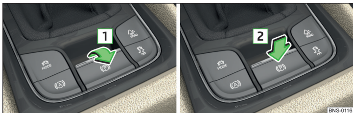
Fig. 255 Utiliser le frein de stationnement
