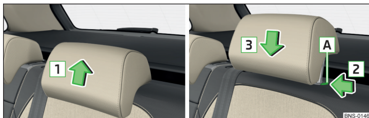
Fig. 99 Régler la hauteur des appuie-têtes de la deuxième rangée de sièges
