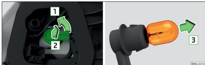
Fig. 379 Remplacer la lampe / monter la lampe
