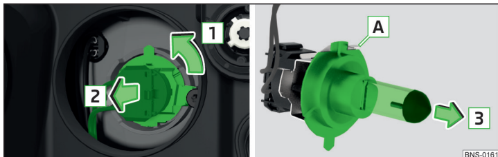
Fig. 371 Remplacement de l'ampoule des feux de route
