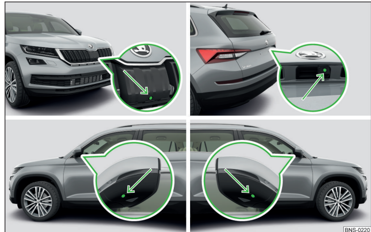
Fig. 283 Emplacement des caméras pour la détection de l'environnement
