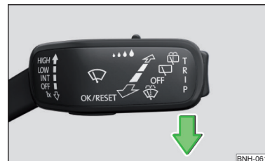
Fig. 361 Régler la position d'entretien des balais d'essuie-glace
