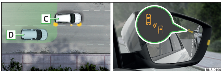
Fig. 275 La situation de conduite / le voyant dans le rétroviseur extérieur de droite indique la situation de conduite
