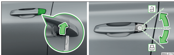
Fig. 356 Poignée dans la portière conducteur : Rabattre le cache de la serrure / déverrouiller et verrouiller
