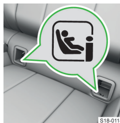
Œillets de fixation pour l'installation du siège enfant avec le système ISOFIX.
