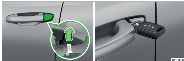
Fig. 232 Poignée dans la portière conducteur : Barillet de serrure recouvert/barillet de serrure avec clé
