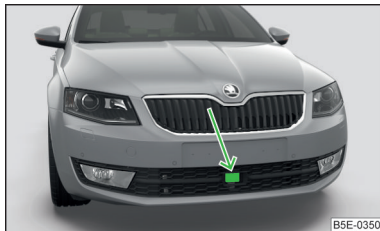
Fig. 154 Emplacement du capteur radar
