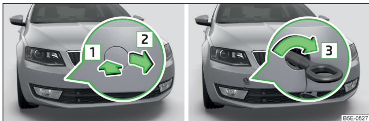
Fig. 227 Démontage du capuchon/montage de l'œillet de remorquage
