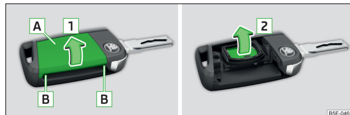
Fig. 230 Démontez le cache / retirez la pile
