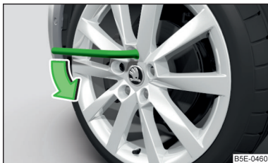
Fig. 220 Changement de roue : Desserrez les boulons de roue
