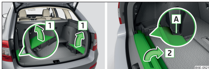
Fig. 121 Retirer le revêtement latéral du coffre à bagages / ranger le couvre-bagages enroulable
