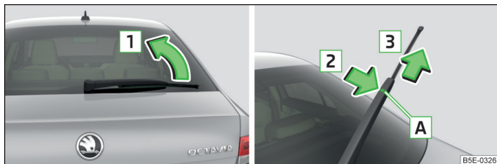
Fig. 349 Remplacez le balai d'essuie-glace de la lunette arrière.
