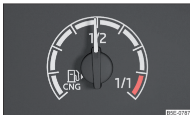
Fig. 31 Affichage du niveau de gaz naturel
