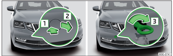
Fig. 337 Retirer le cache / monter l'oeillet de remorquage
