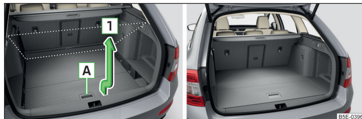
Fig. 140 Réglez le plancher de chargement variable en position supérieure / Plancher de chargement variable en position supérieure
