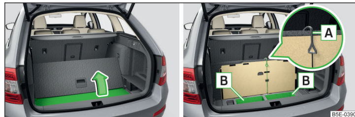
Fig. 136 Lever le revêtement de plancher / Compartiments de rangement sous le revêtement de plancher
