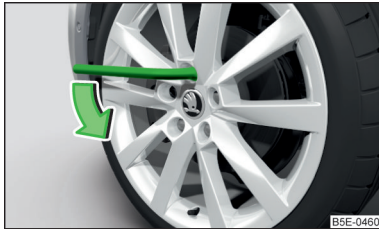
Fig. 331 Desserrez les boulons de roue
