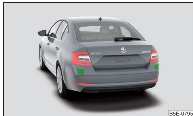
Fig. 256 Emplacement des capteurs radar
