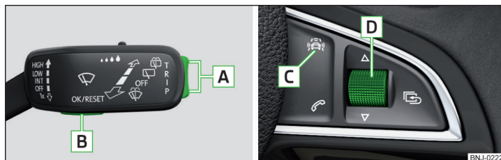
Fig. 288 Touches / molette de réglage : sur la manette de commande / sur le volant multi-fonction
