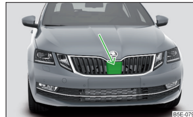
Fig. 251 Emplacement de montage du capteur radar
