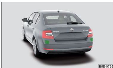
Fig. 259 Emplacement des capteurs radar
