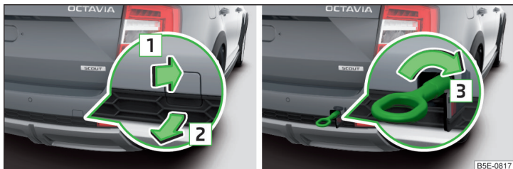
Fig. 340 Retirer le cache / Installer l'œillet de remorquage - Variante 2
