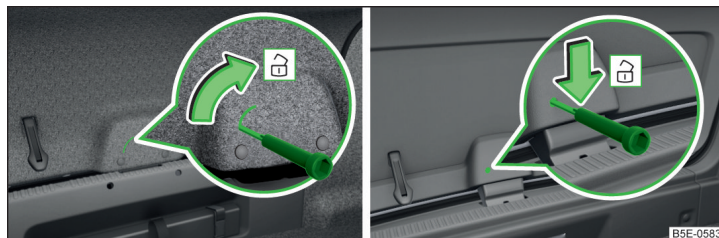
Fig. 346 Déverrouiller le capot variante 1 / variante 2
