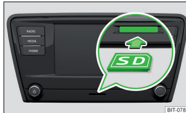
Fig. 186 Swing : Insérer une carte SD
