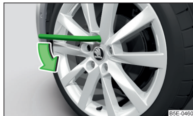
Fig. 332 Desserrez les boulons de roue
