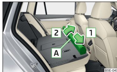
Fig. 150 Démontage du boîtier du filet de séparation
