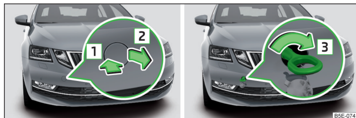
Fig. 338 Retirer le cache / monter l'oeillet de remorquage
