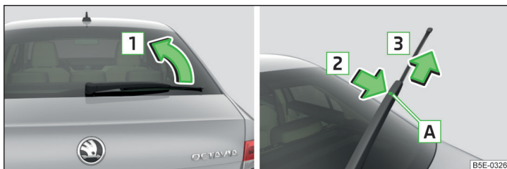
Fig. 350 Remplacez le balai d'essuie-glace de la lunette arrière.
