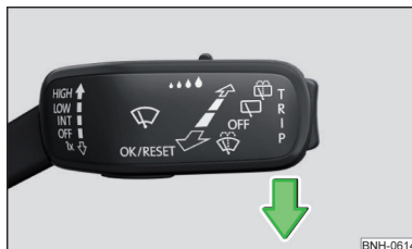
Fig. 348 Régler la position d'entretien des balais d'essuie-glace
