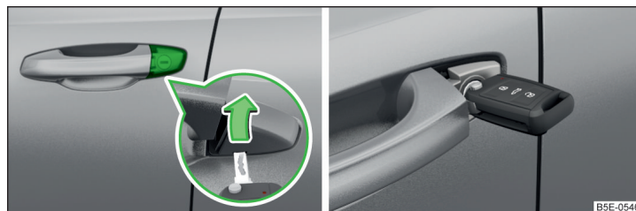
Fig. 344 Poignée dans la portière conducteur : Relever le cache de la serrure / Cylindre de serrure avec clé
