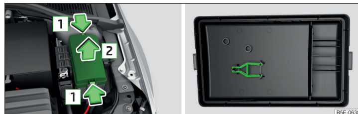
Fig. 355 cache de la boîte à fusibles Retirer le cache / attache en plastique pour les fusibles
