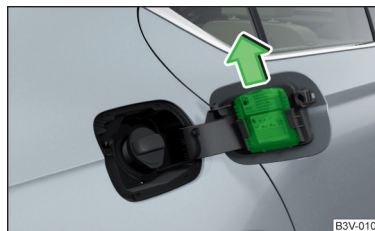
Fig. 309 Emplacement de montage de la raclette à neige, retirer la raclette à neige
