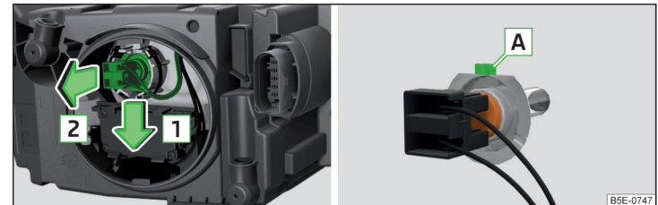
Fig. 358 Remplacement de l'ampoule du feu de croisement
