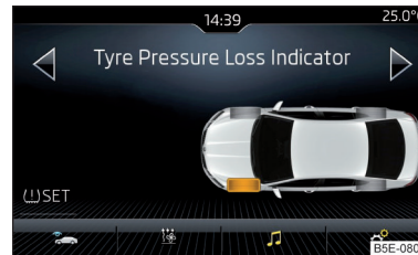
Fig. 296 Touche d'enregistrement / exemple de l'affichage à l'écran : une modification de la pression du pneu avant gauche est indiquée
