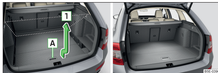
Fig. 144 Réglez le plancher de chargement variable en position supérieure / Plancher de chargement variable en position supérieure
