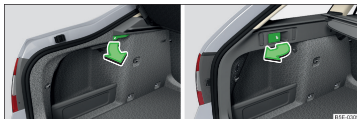
Fig. 89 Rabattre le dossier du siège du coffre à bagages vers l'avant variante 1 / variante 2
