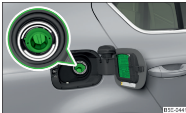
Fig. 312 Tubulure de remplissage de carburant sur les véhicules équipés d'un moteur diesel
