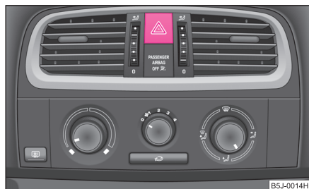
Fig. 35 Tableau de bord: Contacteur pour feux de détresse
