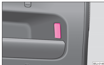
Fig. 195 Déposer l'éclairage du coffre à bagages
