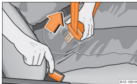
Fig. 144 Enlever le pêne du boîtier de verrouillage
