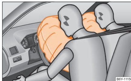
Fig. 147 Sacs remplis de gaz
