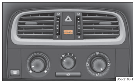
Fig. 154 Témoin de contrôle pour la désactivation de l'airbag du passager avant
