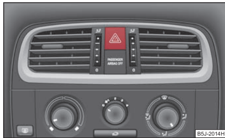
Fig. 50 Tableau de bord: Contacteur pour feux de détresse
