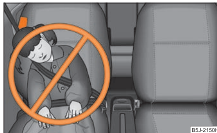
Fig. 156 Un enfant pas correctement protégé, ni assis dans la bonne position – est en danger à cause de l'airbag latéral
