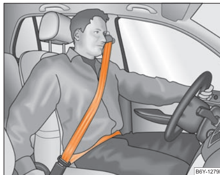
Fig. 141 Position correcte de la sangle boudrier et de la sangle sous-abdominale
