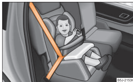
Fig. 159 Siège pour enfant monté à l'arrière dans le sens de déplacement avec tablette de sécurité selon groupe 1
