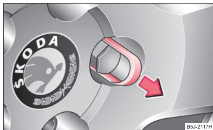
Fig. 191 Changement de roue: Enlever le capuchon du boulon de roue
