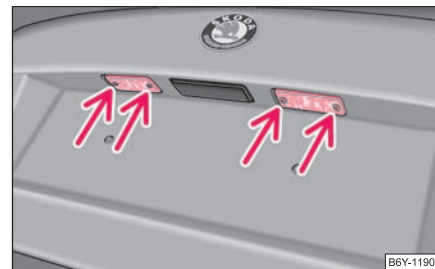
Fig. 211 Déposer l'éclairage de la plaque d'immatriculation
