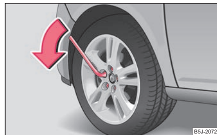
Fig. 192 Changement de roue: Desserer les boulons de roue
