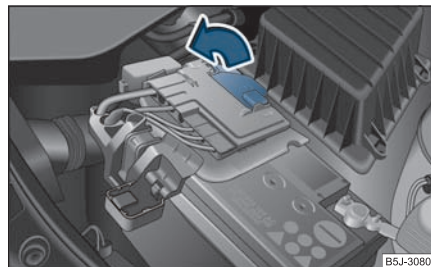
Fig. 182 Batterie: Relever le cache (boîte de vitesses manuelle)
