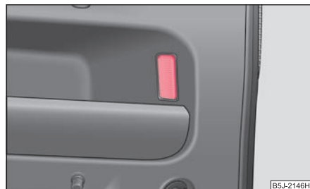
Fig. 216 Déposer l'éclairage du coffre à bagages
