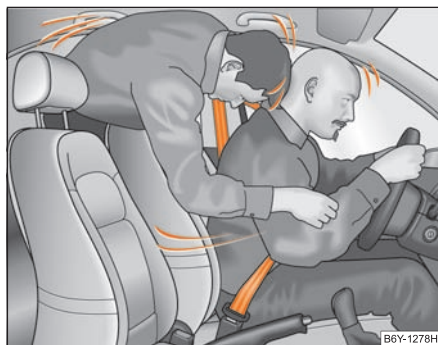
Fig. 140 Une personne assise à l'arrière et pas attachée est catapultée en avant.
