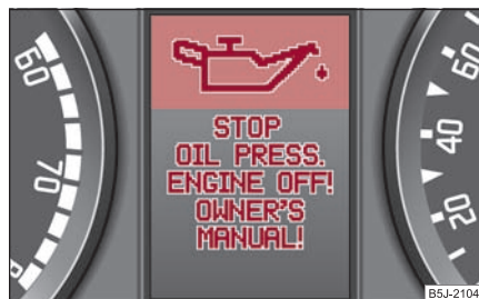
Fig. 28 Ecran d'informations: pression d'huile insuffisante
