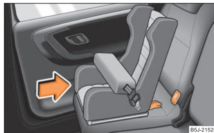
Fig. 163 Les sièges pour enfants ISOFIX sont insérés dans les ergots déjà montés
