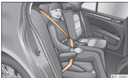
Fig. 186 Siège pour enfant monté sur le siège arrière dans le sens de déplacement selon groupe 3
