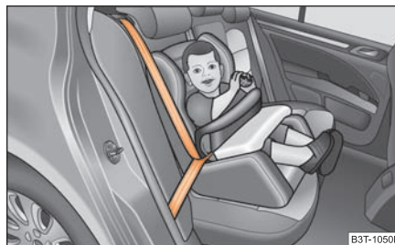
Fig. 184 Siège pour enfant monté à l'arrière dans le sens de déplacement avec tablette de sécurité selon groupe 1
