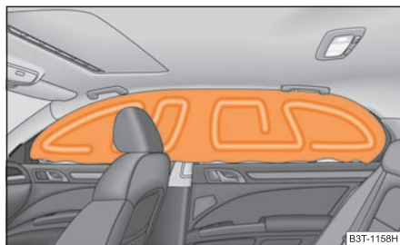
Fig. 177 Airbag de tête rempli de gaz
