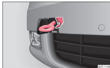
Fig. 225 Pare-chocs avant: Pose des œillets de remorquage
