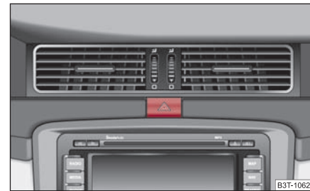
Fig. 60 Tableau de bord: Contacteur pour feux de détresse
