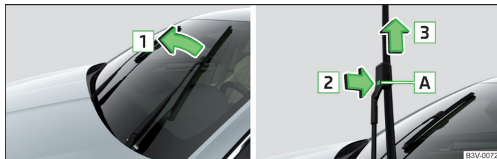
Fig. 354 Changer le balai d'essuie-glace du pare-brise avant
