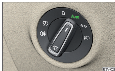
Fig. 50 Commutateur des feux : position AUTO
