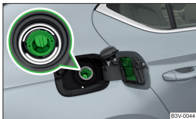
Fig. 316 Tubulure de remplissage de carburant sur les véhicules équipés d'un moteur diesel
