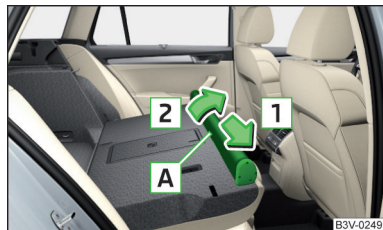
Fig. 145 Démontage du boîtier du filet de séparation
