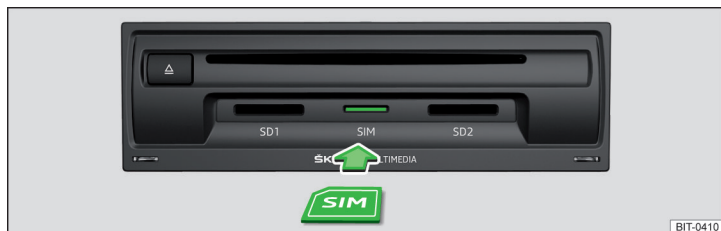
Fig. 202 Insérer la carte SIM dans le module externe
