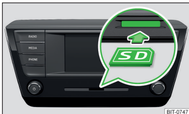
Fig. 188 Infodivertissement Swing : Insérer une carte SD
