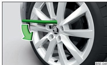
Fig. 335 Desserrer les boulons de roue
