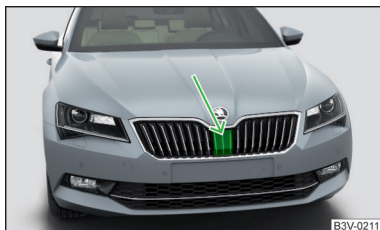
Fig. 264 Emplacement du capteur radar
