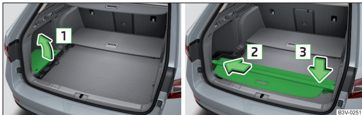
Fig. 129 Retirer le couvre-bagages à gauche / ranger le couvre-bagages enroulable
