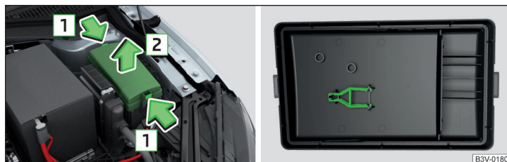
Fig. 361 Cache de la boîte à fusibles : retirer le cache / agrafe en plastique pour les fusibles
