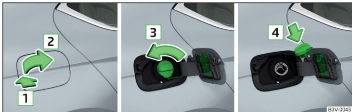
Fig. 315 Ouvrir la trappe du réservoir / Dévisser le bouchon du réservoir / Placer le bouchon du réservoir sur la trappe du réservoir
