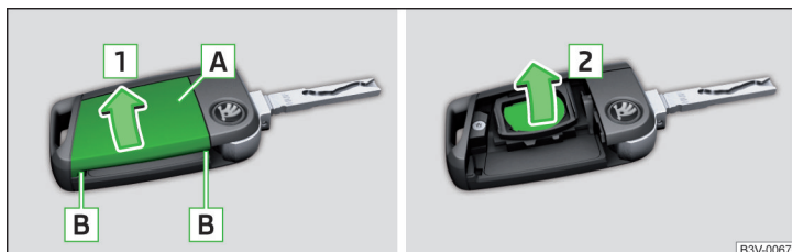
Fig. 343 Enlever le cache / retirer la pile
