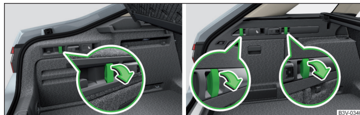
Fig. 123 Rabattre les crochets vers le bas : version 1 / version 2
