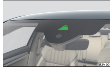
Fig. 53 Capteur de vitre pour l'assistant feux de route
