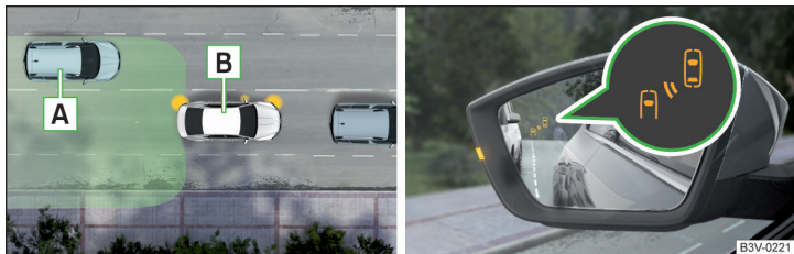
Fig. 273 La situation de conduite / le voyant dans le rétroviseur extérieur de gauche indique la situation de conduite
