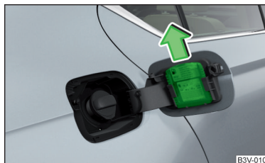
Fig. 313 Emplacement de la raclette, enlever la raclette
