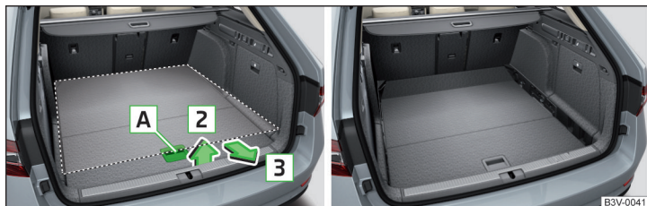
Fig. 140 Réglage le plancher de chargement variable en position inférieure / Plancher de chargement variable en position inférieure
