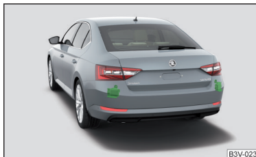
Fig. 271 Emplacement des capteurs de radar
