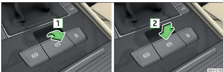
Fig. 256 Utiliser le frein de stationnement
