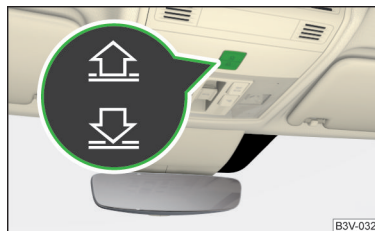
Fig. 47 Touches de commande pour l'utilisation du store pare-soleil
