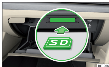
Fig. 187 Infodivertissement Columbus, Amundsen et Bolero : Insérer une carte SD
