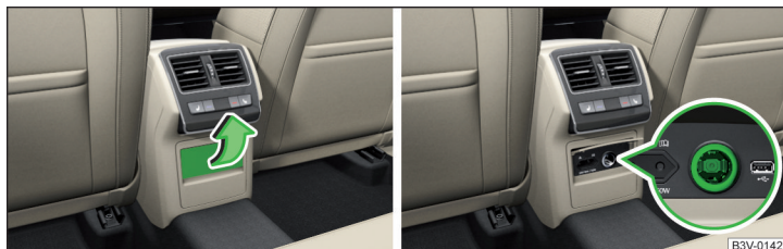
Fig. 109 Rabattre le cache / prise 12 volts
