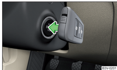
Fig. 252 Démarrer le moteur - maintenir la clé sur le bouton
