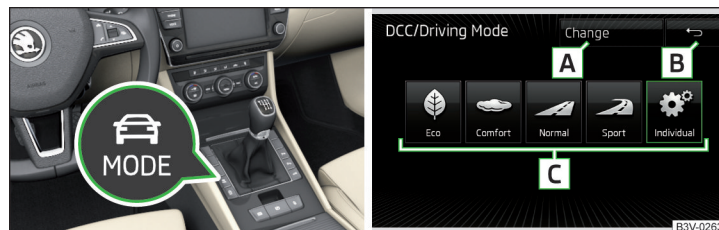
Fig. 302 Bouton pour le choix du mode de conduite / affichage sur l'écran de l'Infodivertissement
