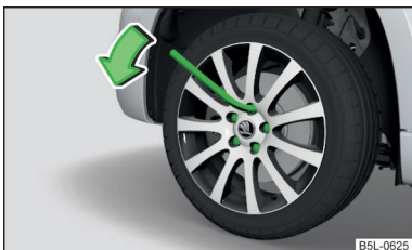
Fig. 174 Changement de roue : Desserrer les boulons de roue
