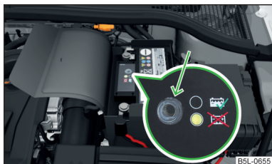
Fig. 165 indicateur de niveau de l'électrolyte
