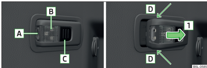
Fig. 104 Commande de la lampe/Démontage de la lampe
