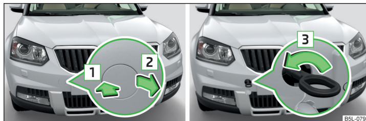
Fig. 182 Démontez le couvercle / Montez l'œillet de remorquage
