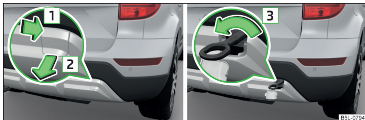
Fig. 183 Démontez le couvercle / Montez l'œillet de remorquage
