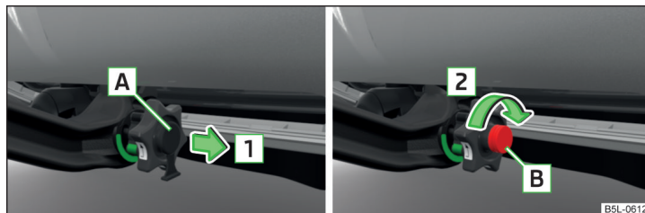
Fig. 153 Enlever le cache de serrure/Déverrouiller la serrure
