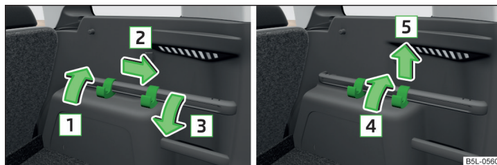
Fig. 98 Faire coulisser les crochets sur la baguette de fixation / démonter les crochets
