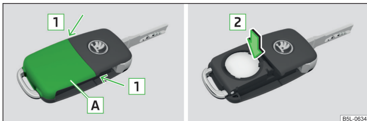
Fig. 184 Démonter le cache / retirer la pile
