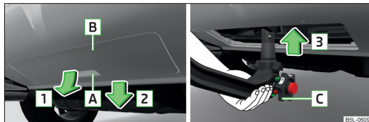
Fig. 150 Enlever le capuchon du pare-chocs arrière / Insérer la boule d'attelage
