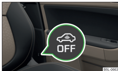
Fig. 35 Touche pour la surveillance de l'habitacle et la protection anti-soulèvement
