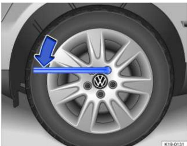
Fig. 204 Changement de roue : desserrage des boulons de roue
