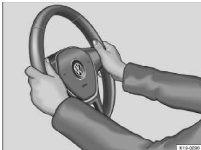
Fig. 68 Sur le volant : positions 9 h et 3 h
