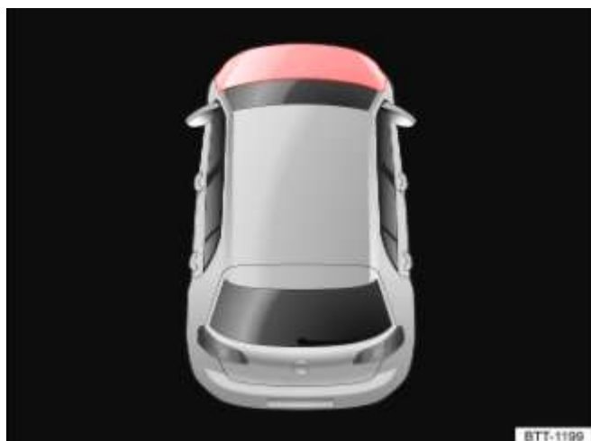
Fig. 185 Sur l'afficheur du combiné d'instruments : capot avant ouvert ou mal fermé (schéma de principe)
