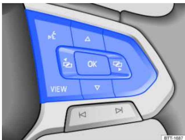
Fig. 16 Côté droit du volant multifonction : touches de commande des menus et des informations dans le combiné d'instruments (variante 1)
