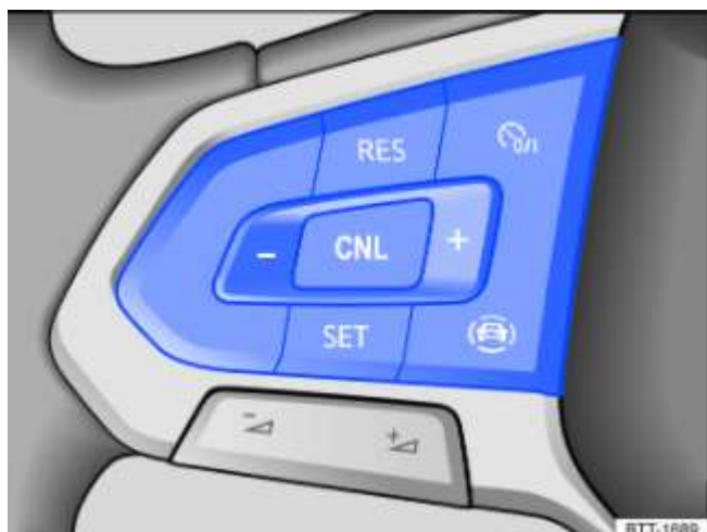
Fig. 120 Côté gauche du volant multifonction : touches de commande de l'assistant de conduite (Travel Assist) (variante 1)
