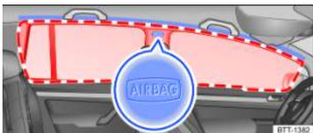
Fig. 38 Côté gauche du véhicule : emplacement de montage et zone de déploiement du sac gonflable de tête
