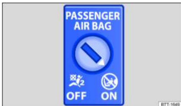
Fig. 35 Dans le tableau de bord côté passager avant : commande à clé pour la désactivation et l'activation du sac gonflable du passager avant
