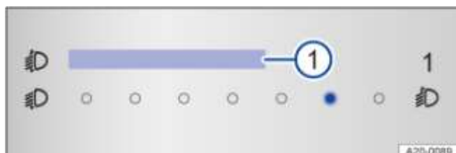
Fig. 86 Dans le système d'infodivertissement : curseur tactile de réglage du site des projecteurs
