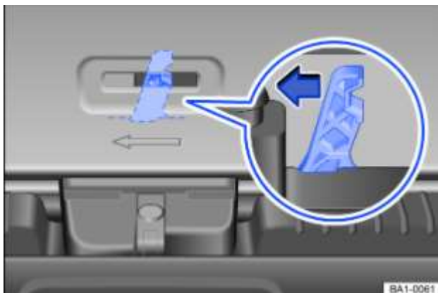
Fig. 65 Dans le coffre à bagages : ouverture d'entretien dans le capot arrière
