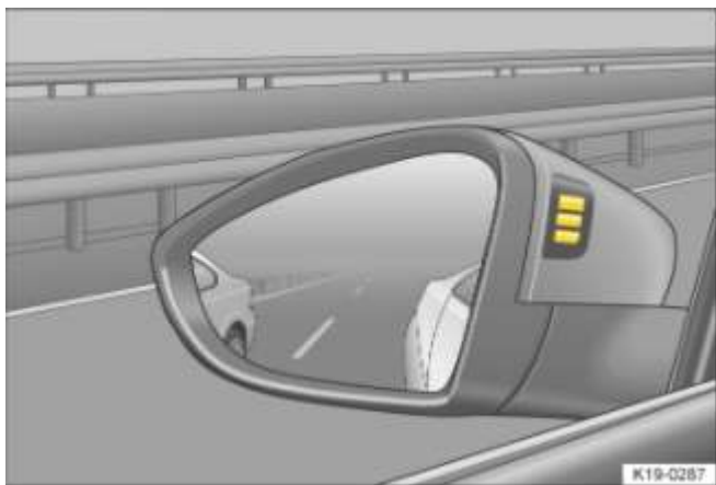
Fig. 122 Dans le boîtier du rétroviseur extérieur : voyant de l'assistant de changement de voie
