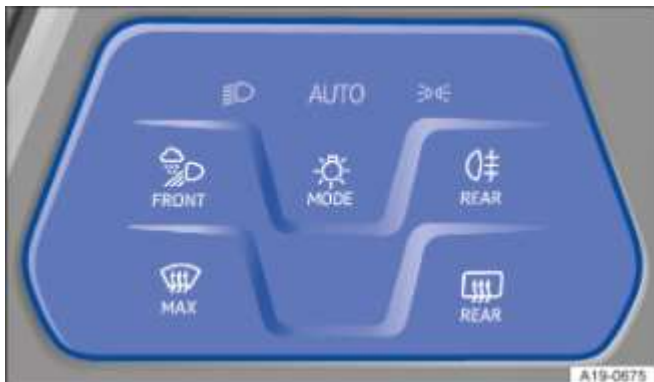
Fig. 83 Près du volant : panneau tactile pour allumer l'éclairage extérieur
