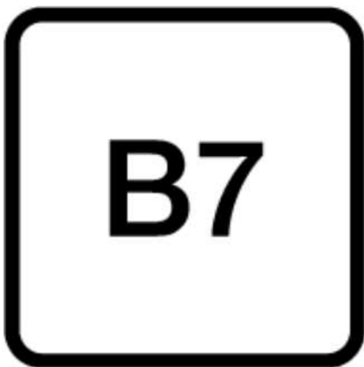
Fig. 156 Gazoles avec teneur en biogazole
