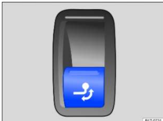
Fig. 152 À droite dans le coffre à bagages : touche de déverrouillage de la boule d'attelage
