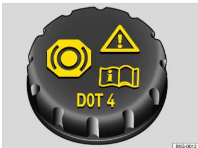
Fig. 191 Dans le compartiment-moteur : bouchon du réservoir de liquide de frein
