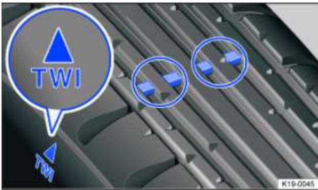
Fig. 198 Sculptures du pneu : indicateurs d'usure
