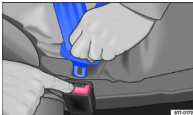
Fig. 27 Retrait du pêne du boîtier de verrouillage
