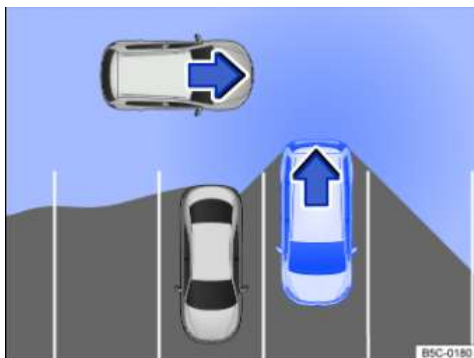
Fig. 134 Schéma de principe de l'assistant de sortie de stationnement : zone surveillée autour du véhicule sortant de la place de stationnement
