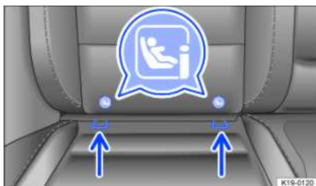
Fig. 44 Repérage des points d'ancrage i-Size pour sièges pour enfants sur le siège du passager avant
