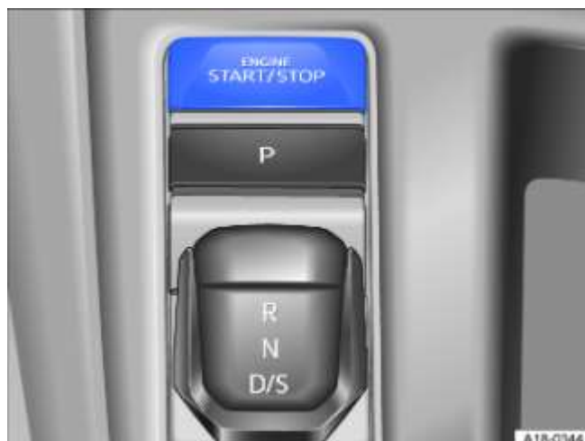
Fig. 101 Dans la partie inférieure de la console centrale : bouton de démarrage du moteur (véhicules avec boîte DSG à double embrayage)
