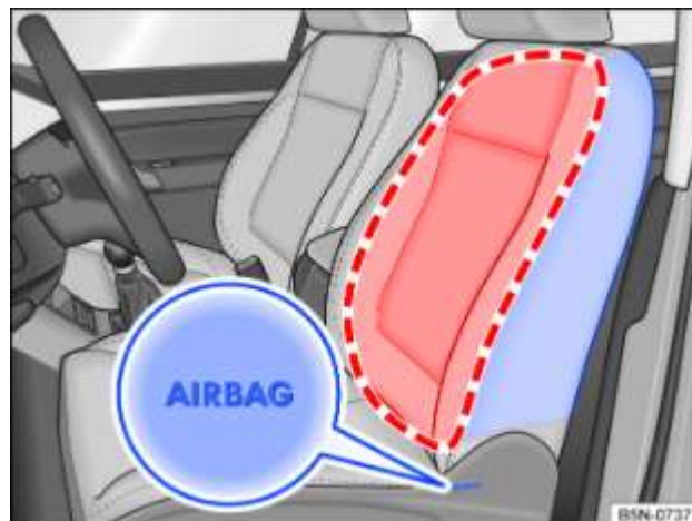
Fig. 37 Sur le côté du siège avant : emplacement de montage et zone de déploiement du sac gonflable latéral
