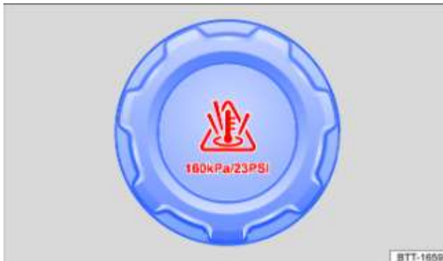
Fig. 190 Dans le compartiment-moteur : bouchon du vase d'expansion du liquide de refroidissement (schéma de principe)
