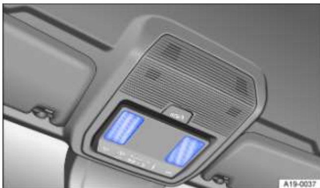
Fig. 87 Dans la console de pavillon : lampes de lecture tactiles
