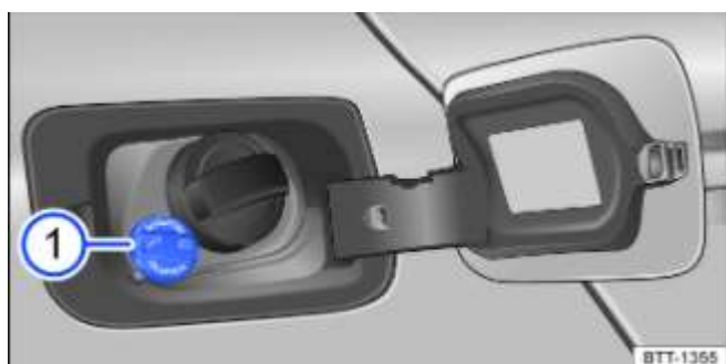
Fig. 160 Derrière la trappe à carburant : bouchon de réservoir d'AdBlue (schéma de principe)
