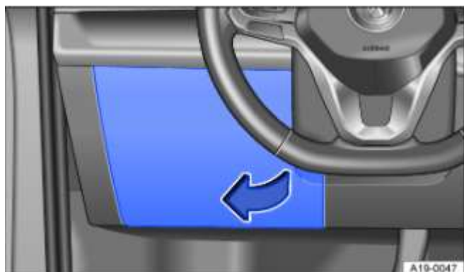
Fig. 170 Côté conducteur dans le tableau de bord : cache de la boîte à fusibles
