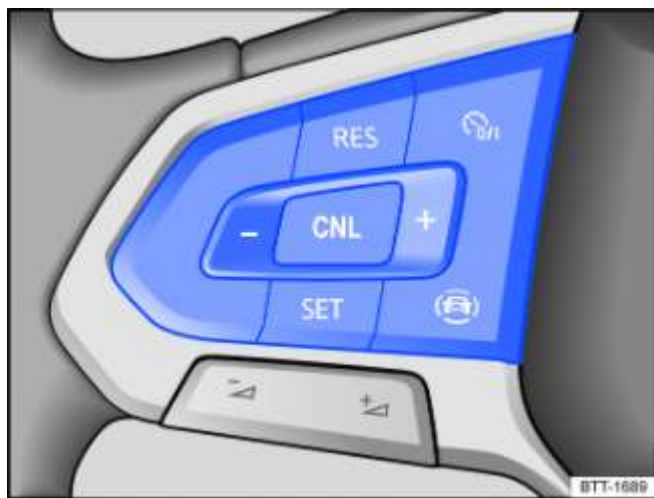
Fig. 106 Côté gauche du volant multifonction : touches de commande du régulateur de vitesse (variante 1)
