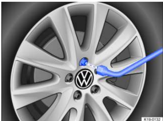
Fig. 212 Changement de roue : dévissage des boulons de roue avec la clé de roue
