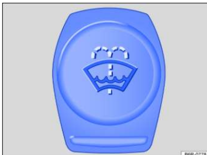
Fig. 186 Dans le compartiment-moteur : bouchon du réservoir de lave-glace
