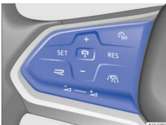
Fig. 121 Côté gauche du volant multifonction : touches de commande de l'assistant de conduite (Travel Assist) (variante 2)
