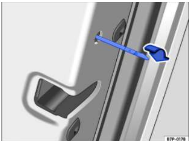
Fig. 61 Sur le chant de la porte arrière droite : verrouillage de secours du véhicule à l'aide de la clé de secours
