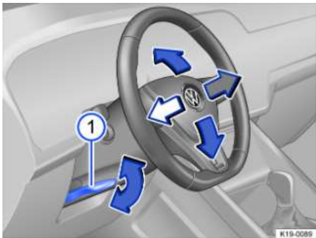
Fig. 67 Sous le volant, dans le revêtement de la colonne de direction : levier de réglage mécanique de la position du volant
