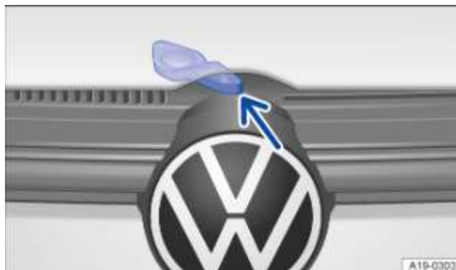
Fig. 182 Au-dessus de la grille de calandre : levier de commande du capot avant
