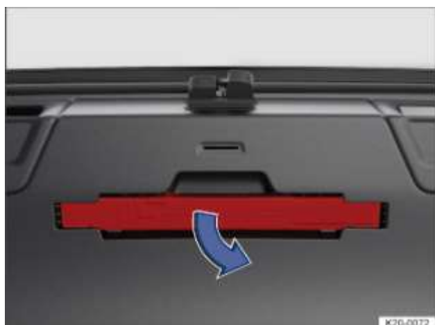
Fig. 48 Dans le capot arrière : support du triangle de présignalisation
