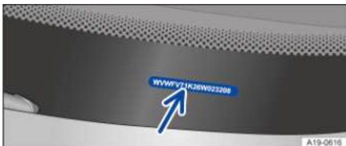
Fig. 219 Sur le pare-brise : numéro d'identification du véhicule
