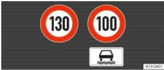
Fig. 14 Sur l'afficheur du combiné d'instruments : exemples de limitations de vitesse détectées avec les panonceaux correspondants
