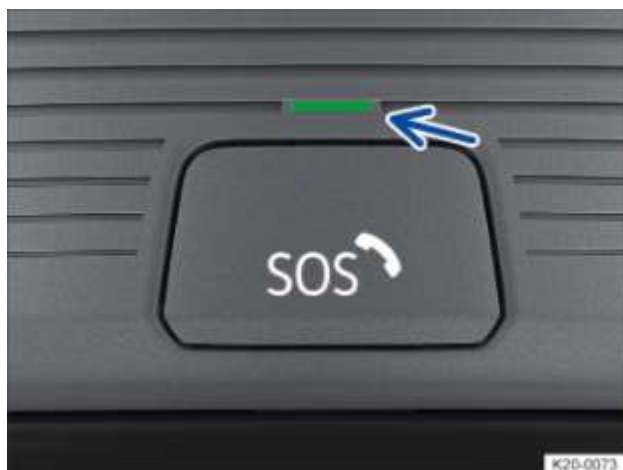
Fig. 52 Dans la console de pavillon : éléments de commande pour le système d'appel d'urgence légal eCall (derrière le couvre-touche)
