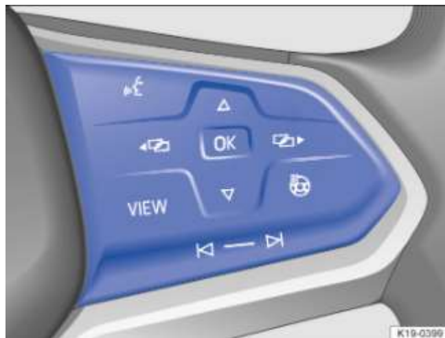
Fig. 17 Côté droit du volant multifonction : touches de commande des menus et des informations dans le combiné d'instruments (variante 2)
