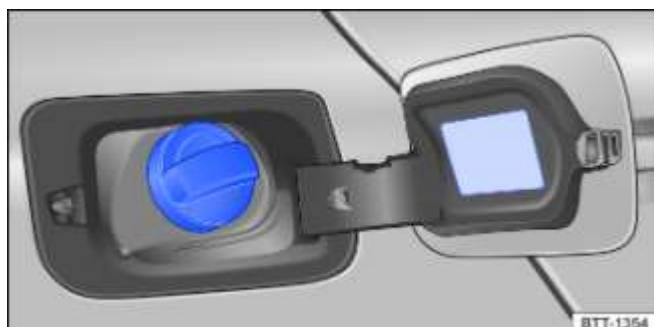
Fig. 158 Derrière la trappe à carburant : bouchon de réservoir (schéma de principe)
