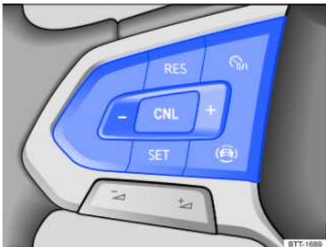
Fig. 108 Côté gauche du volant multifonction : touches de commande du limiteur de vitesse (variante 1)
