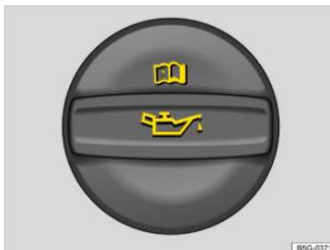
Fig. 188 Dans le compartiment-moteur : bouchon de l'orifice de remplissage d'huile-moteur (schéma de principe)
