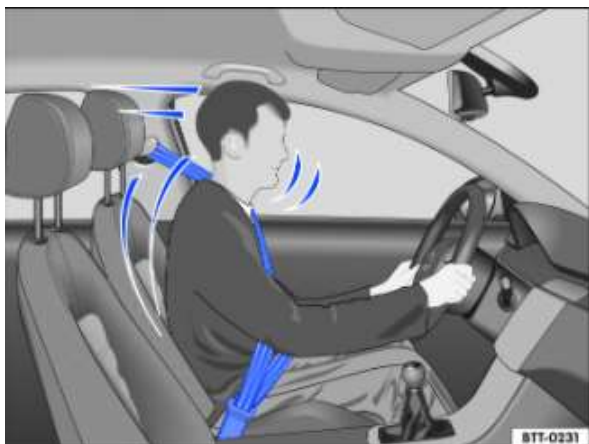
Fig. 25 Conducteur correctement attaché, retenu par sa ceinture de sécurité lors d'un freinage brusque
