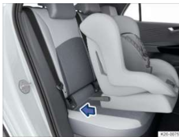
Fig. 45 Schéma de principe : installation d'un siège pour enfants avec verrous
