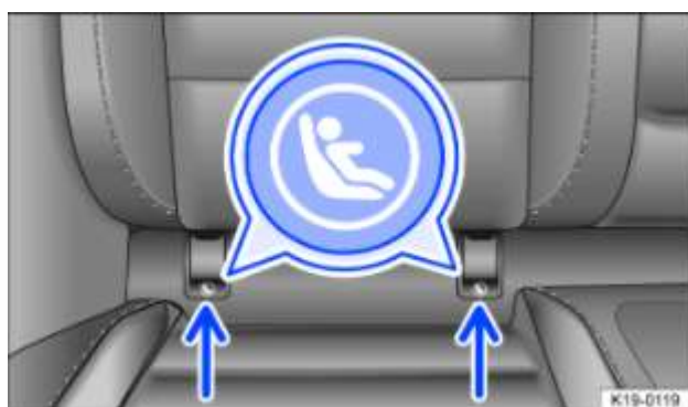
Fig. 42 Repérage des points d'ancrage ISOFIX pour sièges pour enfants aux places de la banquette arrière
