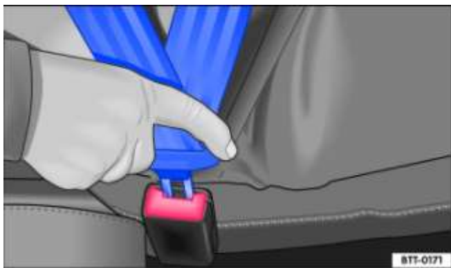
Fig. 26 Insertion du pêne de la ceinture de sécurité dans le boîtier de verrouillage
