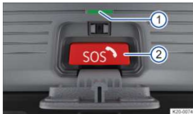
Fig. 53 Élément de commande pour l'appel d'urgence : témoin de contrôle et touche
