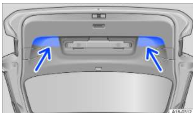
Fig. 64 Capot arrière ouvert : poignée concave pour la fermeture
