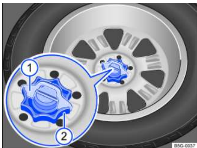
Fig. 208 Dans le coffre à bagages : molette pour la fixation de la roue de secours
