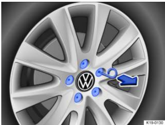
Fig. 203 Retrait des capuchons de boulons de roue
