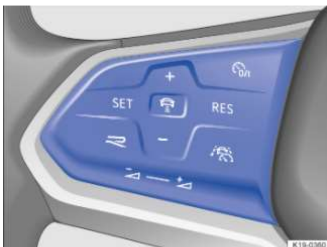
Fig. 116 Côté gauche du volant multifonction : touches de commande du régulateur de distance (variante 2)
