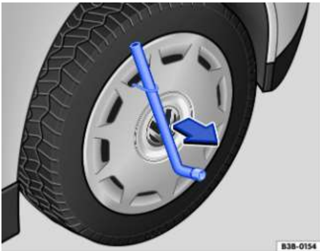
Fig. 202 Retrait de l'enjoliveur de roue plein
