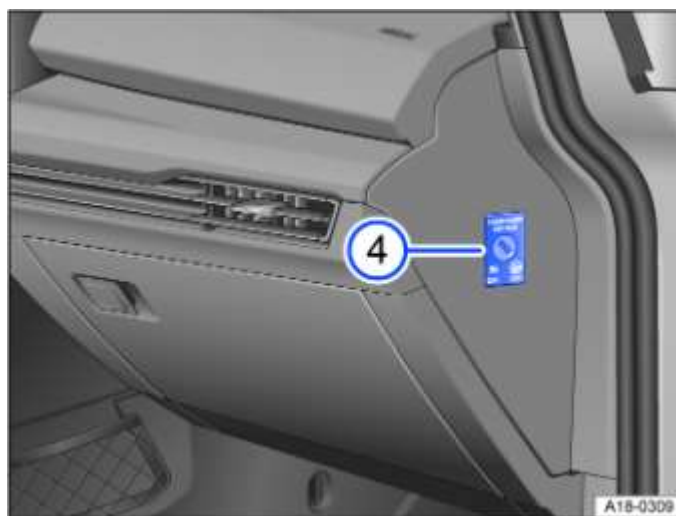
Fig. 8 Avec la porte du passager avant ouverte (véhicules à direction à gauche) : commande à clé dans le tableau de bord
