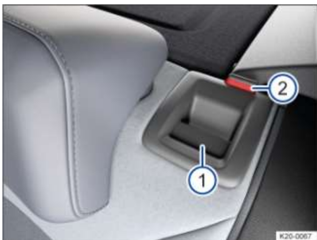
Fig. 73 Dans le dossier de banquette arrière : touche de déverrouillage
