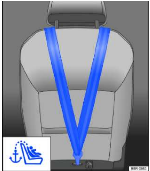
Fig. 47 Au dos du siège du passager avant : ceinture de retenue supérieure accrochée
