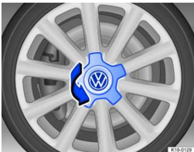
Fig. 201 Retrait de l'enjoliveur central par rotation
