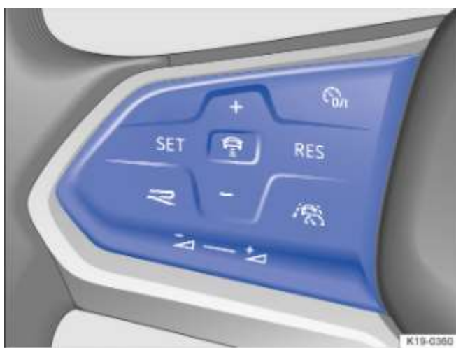
Fig. 107 Côté gauche du volant multifonction : touches de commande du régulateur de vitesse (variante 2)
