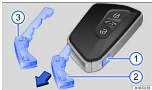
Fig. 55 Clé du véhicule : déverrouillage de la clé de secours
