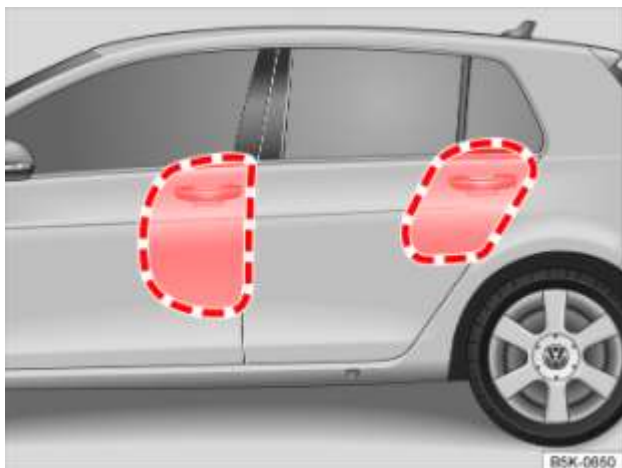
Fig. 36 Côté gauche du véhicule : zones de déploiement des sacs gonflables latéraux
