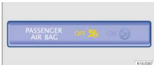
Fig. 31 Dans la console de pavillon : témoin de contrôle (schéma de principe) pour la désactivation du sac gonflable du passager avant
