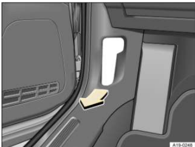
Fig. 181 Au plancher du côté conducteur : levier de déverrouillage du capot avant (schéma de principe)
