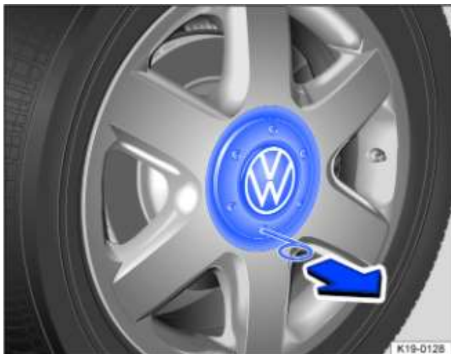
Fig. 200 Retrait de l'enjoliveur central par extraction
