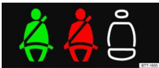
Fig. 20 Sur l'afficheur du combiné d'instruments : indicateur de statut des ceintures pour les places arrière
