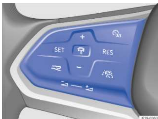
Fig. 109 Côté gauche du volant multifonction : touches de commande du limiteur de vitesse (variante 2)
