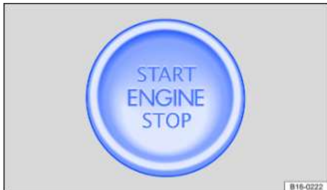
Fig. 100 Dans la partie inférieure de la console centrale : bouton de démarrage du moteur (véhicules avec boîte mécanique)
