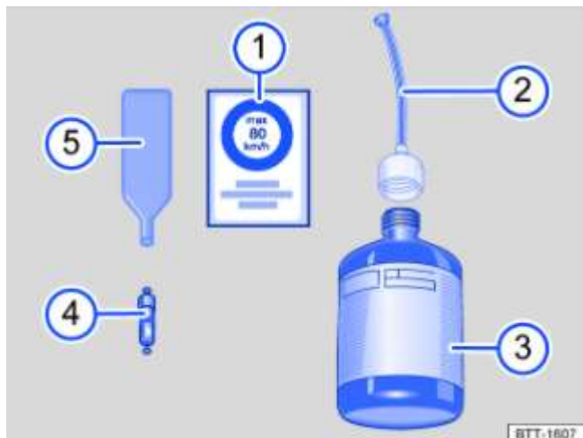
Fig. 213 Schéma de principe : composition du kit de crevaison
