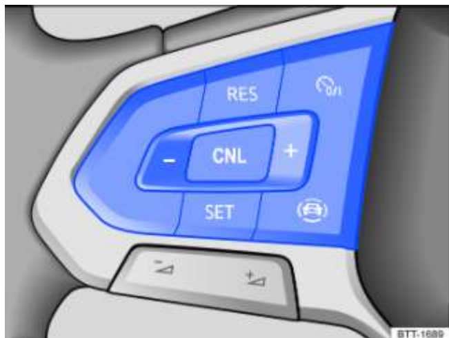
Fig. 115 Côté gauche du volant multifonction : touches de commande du régulateur de distance (variante 1)
