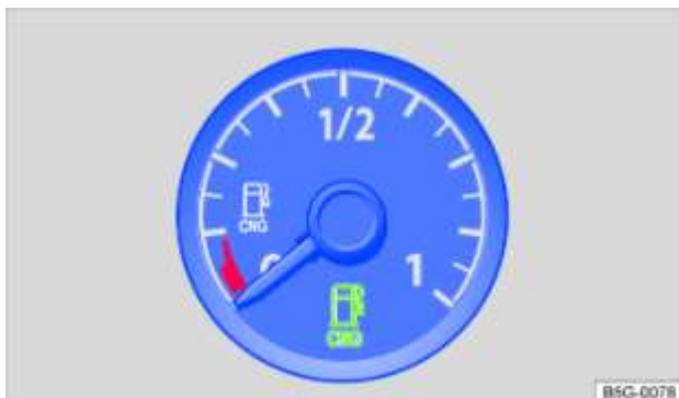
Fig. 10 Indicateur de niveau de carburant pour gaz naturel dans le combiné d'instruments analogique
