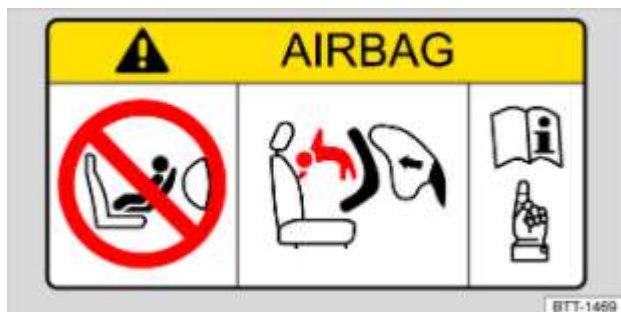
Fig. 40 Schéma de principe : étiquette de sac gonflable sur le pare-soleil
