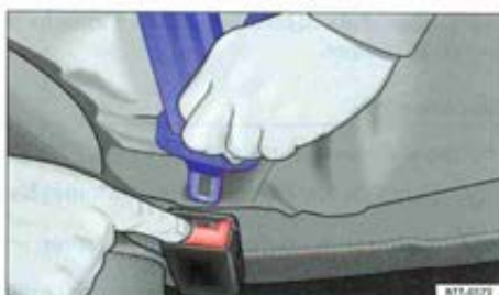
Fig. 54 Retrait du pêne du boîtier de verrouillage.
