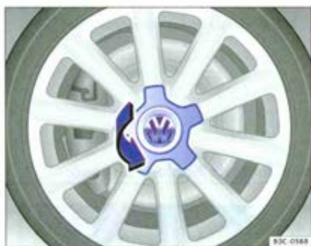
Fig. 188 Retrait de l'enjoliveur central par un mouvement de rotation
