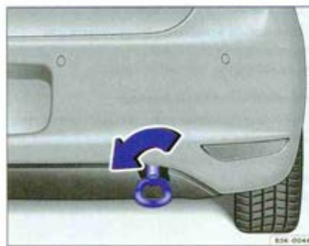
Fig. 213 Dans le pare-chocs arrière, du côté droit : œillet de remorquage vissé.
