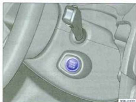
Fig. 117 Système sans clé de fermeture et de démarrage KESSY : bouton de démarrage
