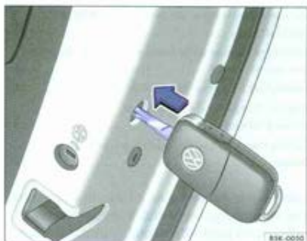
Fig. 179 Verrouillage d'urgence du véhicule à l'aide de la clé du véhicule
