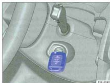
Fig. 118 Fonction de démarrage d'urgence sur les véhicules avec KESSY.
