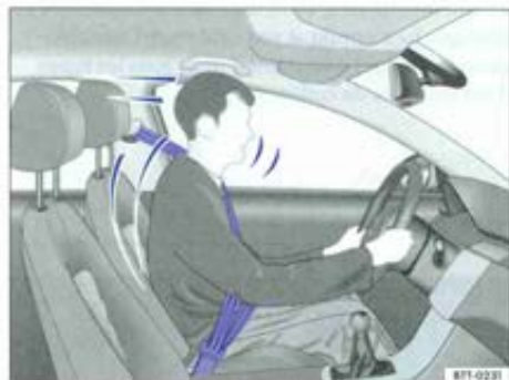
Fig. 52 Conducteur correctement sanglé, retenu par sa ceinture de sécurité lors d'un freinage brusque.
