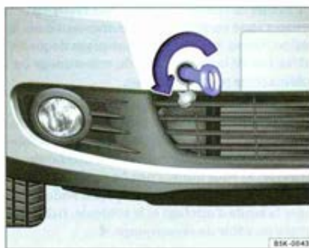
Fig. 212 Dans le pare-chocs avant, du côté droit : vissage de l'œillet de remorquage
