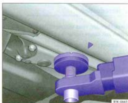
Fig. 174 Levage avec le pont élévateur : points de prise arrière.
