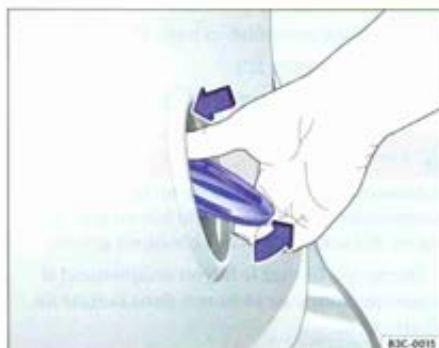
Fig. 27 Ouverture du hayon depuis l'extérieur.
