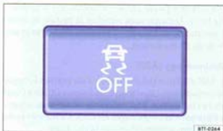
Fig. 129 Dans la console centrale : touche de désactivation et d'activation manuelles de la fonction ASR (véhicules avec ESP).
