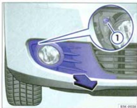
Fig. 202 Dans le pare-chocs avant, du côté droit : dépose du projecteur.
