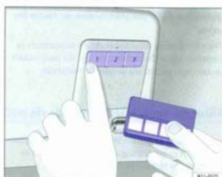
Fig. 32 Pour la programmation : appuyez simultanément sur une touche de la télécommande de porte de garage et de la radiocommande.
