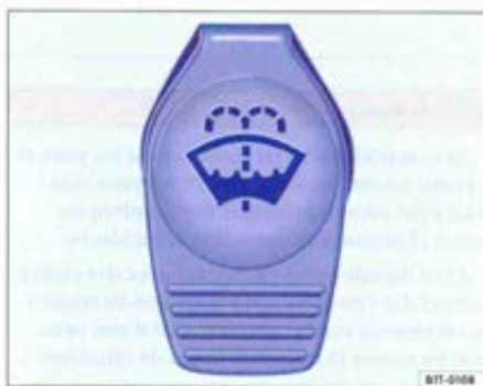
Fig. 82 Dans le compartiment-moteur : bouchon du réservoir de liquide de lave-glace.
