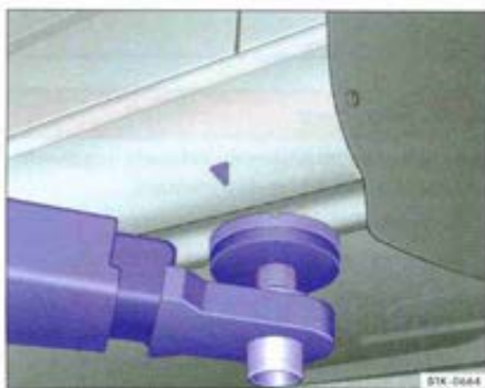
Fig. 173 Levage avec le pont élévateur : points de prise avant.
