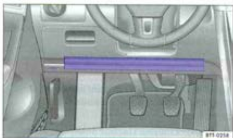
Fig. 62 Côté du conducteur : emplacement de montage du sac gonflable de genoux.
