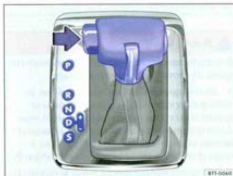
Fig. 124 Véhicules à direction à gauche : levier sélecteur de la boîte automatique avec touche de blocage (flèche).
