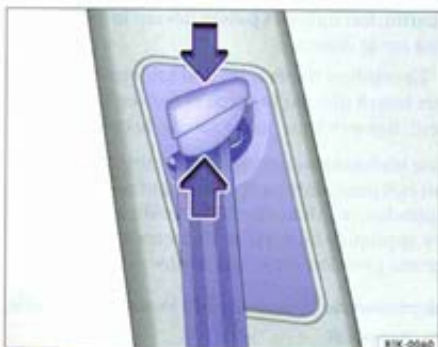
Fig. 57 À côté des sièges avant : réglage en hauteur de la ceinture.
