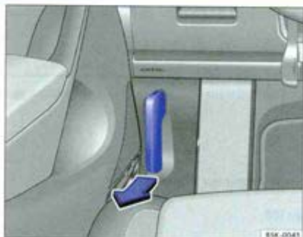
Fig. 157 Au niveau du plancher côté conducteur : levier de déverrouillage du capot-moteur.
