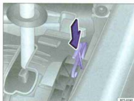
Fig. 184 Déverrouillez d'urgence le blocage du levier sélecteur.
