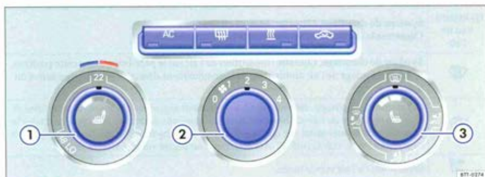
Fig. 147 Dans la console centrale : éléments de commande du Climatic
