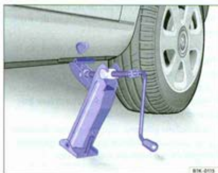
Fig. 194 Positionnement du cric à l'arrière, du côté gauche du véhicule.
