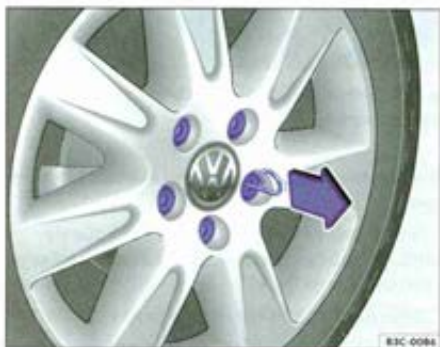
Fig. 190 Retrait des capuchons de boulons de roue
