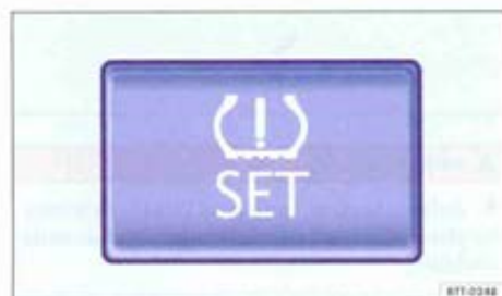
Fig. 146 Dans la console centrale : touche de réglage de l'indicateur de contrôle des pneus.
