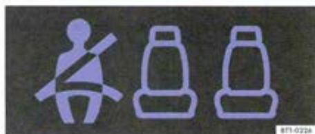
Fig. 47 Indicateur de statut des ceintures pour les places arrière dans le combiné d'instruments.
