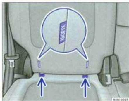
Fig. 69 Variante 2: identification des points d'ancrage inférieurs du siège pour enfants sur le siège du véhicule.
