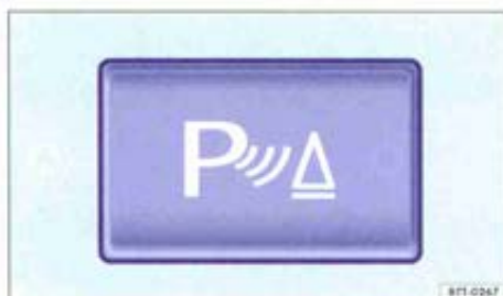
Fig. 134 Dans la console centrale : touche d'activation ou de désactivation du système d'aide au stationnement.
