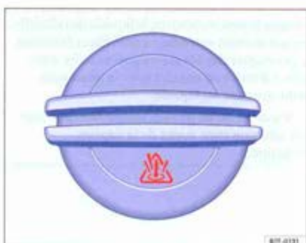
Fig. 163 Dans le compartiment-moteur : bouchon du vase d'expansion du liquide de refroidissement.
