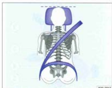
Fig. 34 Ajustement correct de la ceinture et réglage correct de l'appuie-tête.
