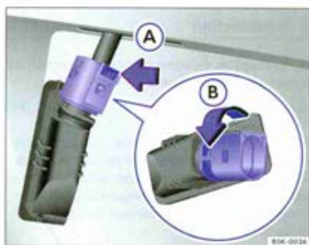
Fig. 209 Feu de plaque de police : dépose du porte-ampoules.
