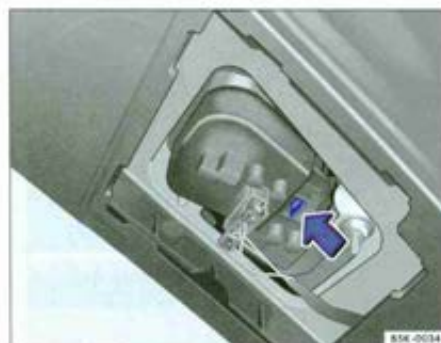
Fig. 205 Retirez le porte-ampoule intégré au capot de coffre.
