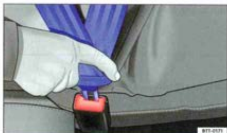
Fig. 53 Insertion du pêne de la ceinture de sécurité dans le boîtier de verrouillage.
