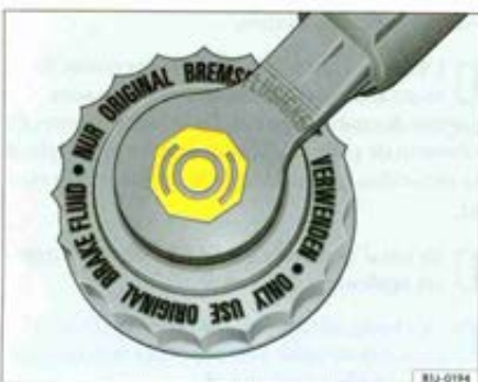
Fig. 131 Dans le compartiment-moteur : bouchon du réservoir de liquide de frein
