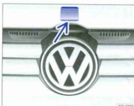
Fig. 158 Levier de déverrouillage permettant d'ouvrir le capot-moteur dans la grille de calandre.
