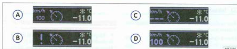
Fig. 143 Sur l'afficheur du combiné d'instruments : indications d'état du régulateur de vitesse.
