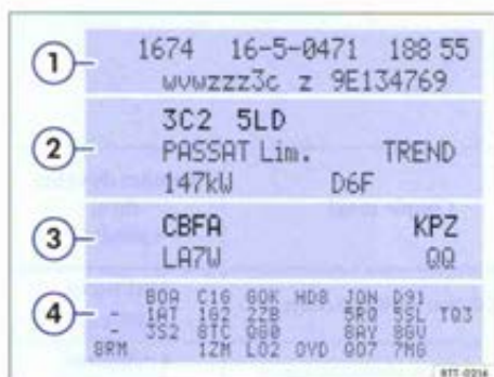
Fig. 12 Plaquette d'identification du véhicule (par ex. avec les lettres-repères moteur CBFA figurant sur la figure ③).
