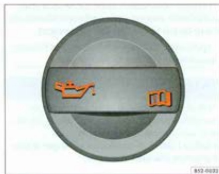
Fig. 160 Dans le compartiment-moteur : bouchon de l'orifice de remplissage d'huile-moteur.
