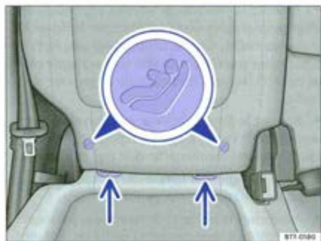
Fig. 68 Variante 1: identification des points d'ancrage inférieurs du siège pour enfants sur le siège du véhicule.
