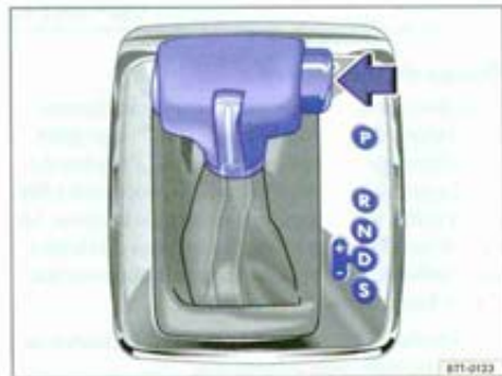
Fig. 125 Véhicules à direction à droite : levier sélecteur de la boîte automatique avec touche de blocage (flèche).
