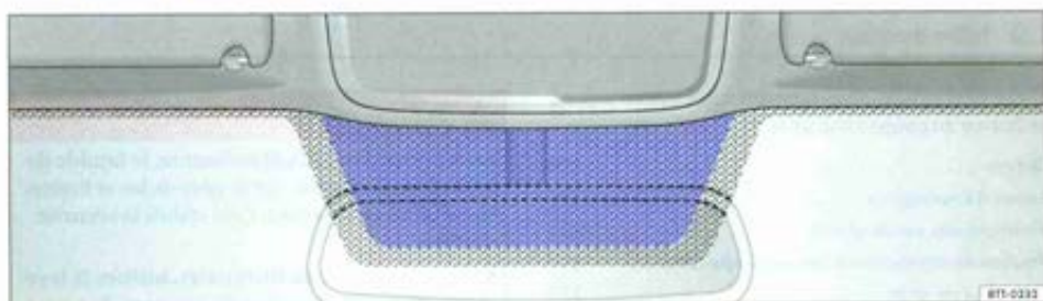
Fig. 76 Pare-brise réfléchissant avec fenêtre de communication (surface bleue).
