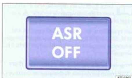
Fig. 130 Dans la console centrale : touche de désactivation et d'activation manuelles de la fonction ASR (véhicules sans ESP).
