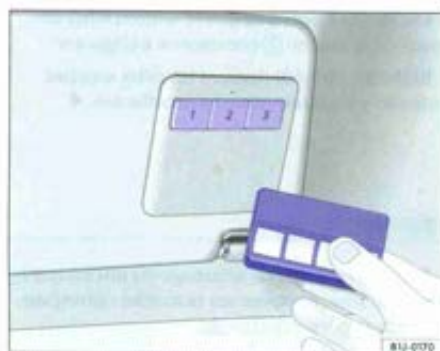
Fig. 31 Radiocommande et touches de la télécommande de porte de garage dans le pare-soleil.
