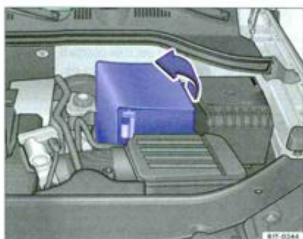
Fig. 165 Dans le compartiment-moteur : rabattement du soufflet de la batterie du véhicule.
