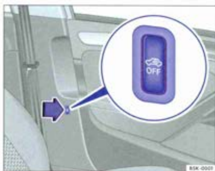
Fig. 22 À côté du siège du conducteur : touche de désactivation de la protection volumétrique et de la protection anti-soulèvement.
