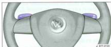
Fig. 127 Volant de direction avec deux palettes pour passage des rapports de la commande Tiptronic.
