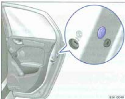
Fig. 178 Sur le chant de la porte arrière droite : verrouillage d'urgence masqué par un joint en caoutchouc.
