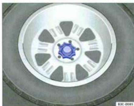
Fig. 171 Dans le coffre à bagages : molette pour la fixation de la roue de secours
