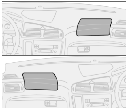
Emplacement du coussin gonflable du côté passager, voitures à conduite à gauche/conduite à droite
