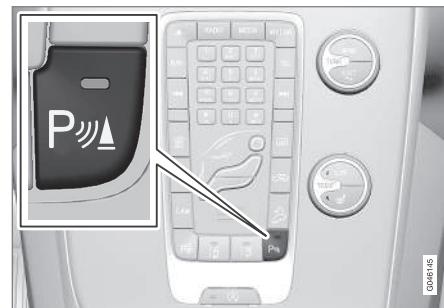
Bouton de marche/arrêt de l'aide au stationnement et de CTA 25 .
