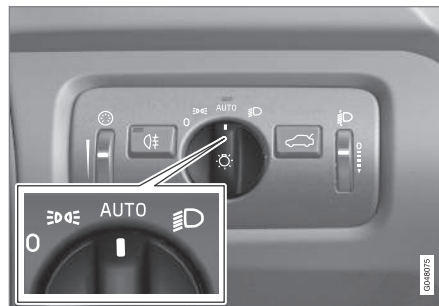
Bouton du commutateur d'éclairage en position AUTO .
