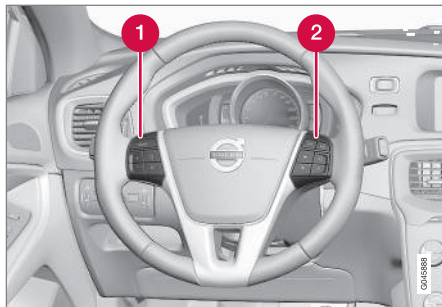
Commandes au volant.
