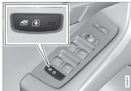
Panneau de commande porte conducteur.
