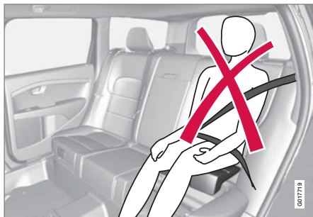
Emplacement incorrect, la tête ne doit pas être placée au-dessus de l'appui-tête et la ceinture ne doit pas passer en dessous du niveau de l'épaule.
