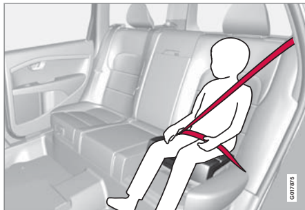
Emplacement correct, la ceinture est placée sur l'épaule.
