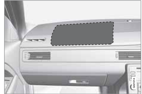
Emplacement du coussin gonflable du côté passager dans les voitures à conduite à droite.
