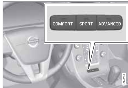
Réglages du châssis.
