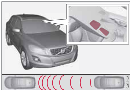
Fenêtre d'émission et de réception du capteur laser 1 .
