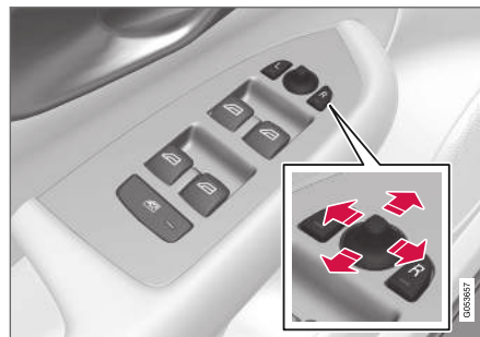
Commande des rétroviseurs extérieurs.
