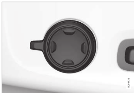
La commande multifonctions, sur les voitures à soutien lombaire quadridirectionnel*.
