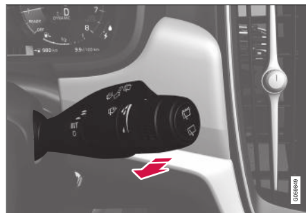
Fonction lave-glace, levier droit au volant
