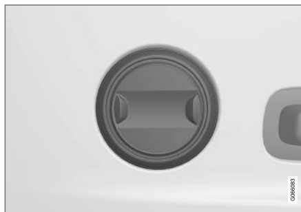
Commande des voitures à soutien lombaire bidirectionnel*
