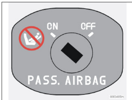
Commutateur pour SRS en position ON.
