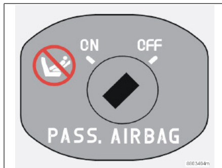
Commutateur pour SRS en position OFF.
