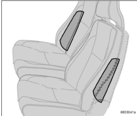
Emplacement des coussins gonflables latéraux.
