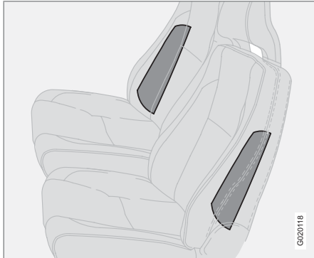
Emplacement des coussins gonflables latéraux.
