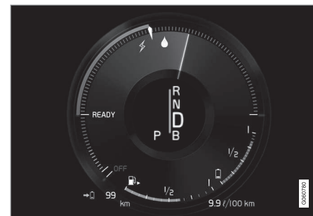
Écran conducteur en cas de marche avant avec moteur électrique et à combustion.
