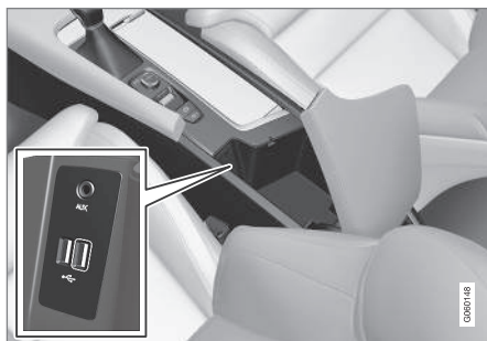
Port USB de la console de tunnel.
